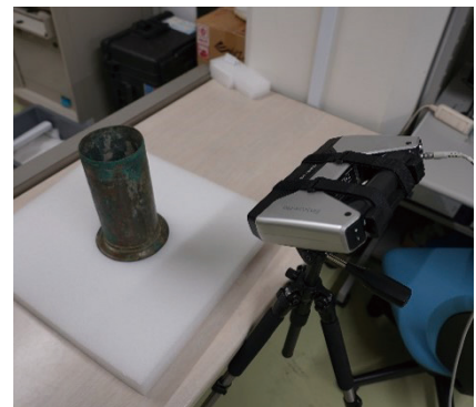
写真5 経筒の三次元計測
